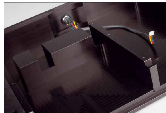
Die Gehäuse wurden aus einem massiven Alublock gefräst. Dicke Wände zwischen den einzelnen Baugruppen sorgen für perfekte Isolierung
