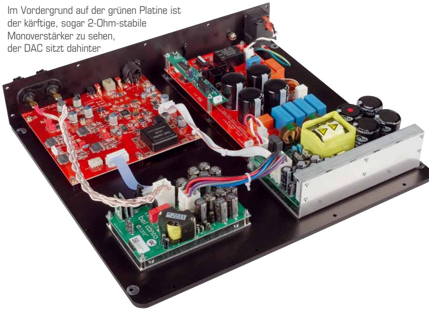
Als D/A-Wandler wird ein anerkannter guter PCM1792 eingesetzt, der dank Monobetrieb noch bessere Dynamikwerte liefern kann
