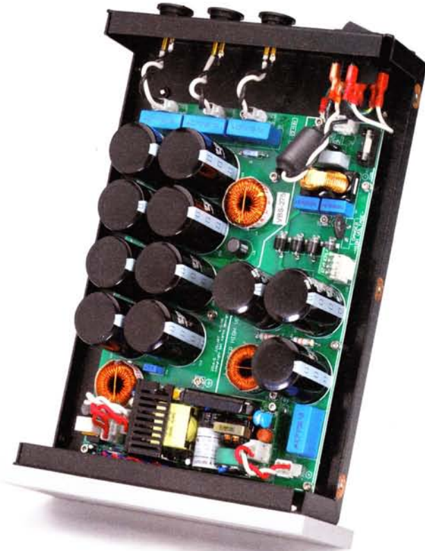
VBS1: Kein echtes Akkunetzteil – deshalb ja auch Virtual Battery Supply –, aber reichlich Siebelkos, um dem Akku-Betrieb möglichst nahe zu kommen
