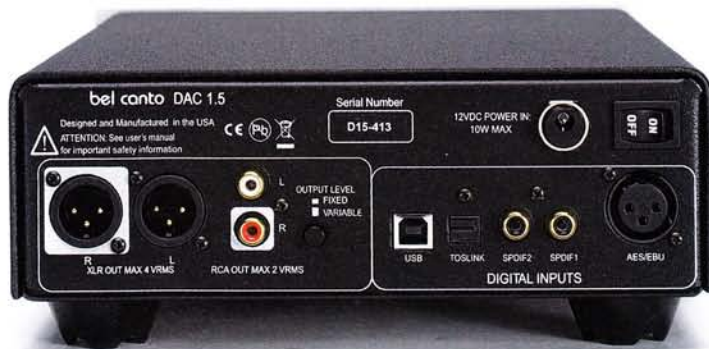
Alles, was man braucht: symmetrische und asymmetrische Ausgänge; USB-, Toslink-, S/PDIF- sowie AES/EBU-Eingang
