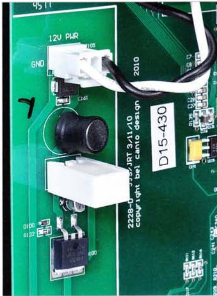
12 Volt Gleichspannungszuführung, die nochmals gesiebt und stabilisiert wird
