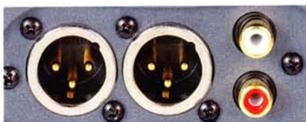
Die Analogabteilung des HD ist vollsymmetrisch aufgebaut
