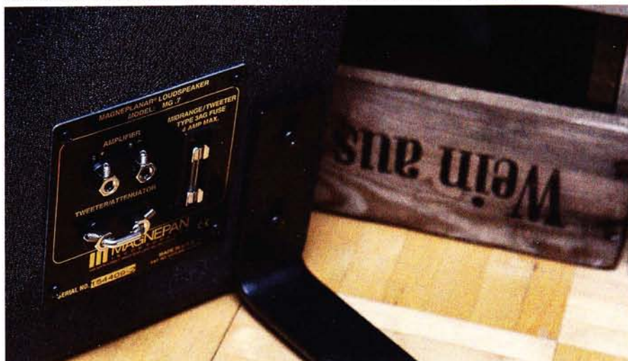
Im nur für Bananenstecker geeigneten Anschlussfeld der Maggie schützt eine Schmelzsicherung vor Überlastung. Statt des Jumpers lässt sich zur Hochtondämpfung ein Widerstand einsetzen.
