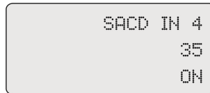
Display nach Umschalten auf den neuen Eingang; Schutzkondensator deaktiviert
