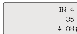
Display im Betriebszustand ON, Schutzkondensator aktiv
