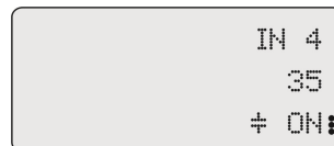
Display im Betriebszustand ON, Schutzkondensator aktiv
