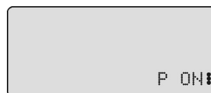
Display im Betriebszustand PROTECT ON
