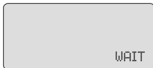
Display nach Einschalten des Netzfilters
