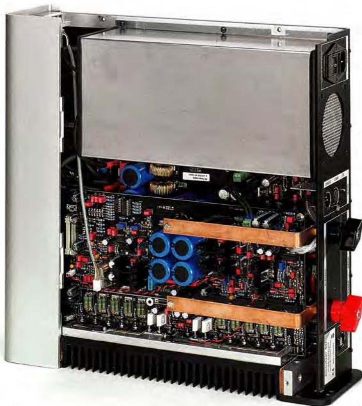
What's Inside of a Girl? Massive Kupferschienen verbinden die Ausgangsstufe der Transistoren-Bank (unten) mit den griffigen Polklemmen
