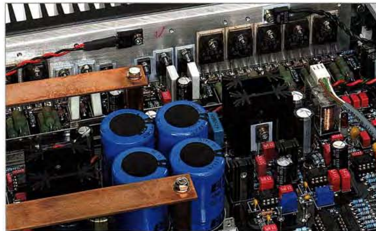
The Heat is On: Eng schmiegen sich Sanken-Transistoren an ihre Kühlrippen. Hohe Bechereikos liefern überdimensionierte Siebkapazität
