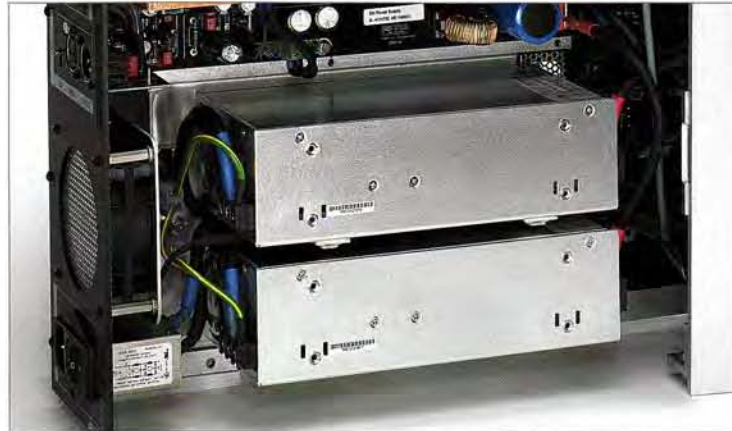
Burning Desire: Zur Kühlung der beiden mächtigen Schaltnetzteile ist ein temperaturgesteuerter Lüfter unerlässlich
