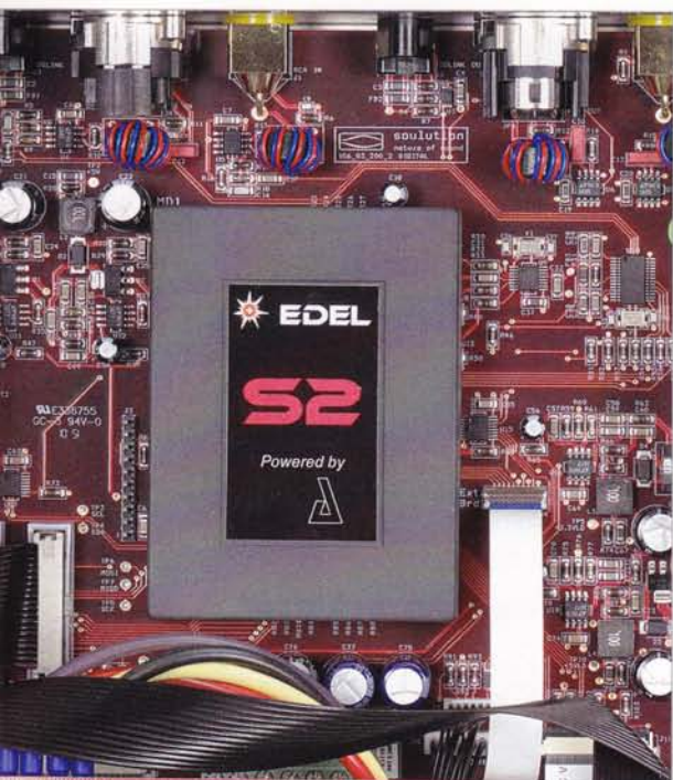
Der Rechenkünstler von Anagramm konvertiert selbst DSD-Daten ins PCM-Format
