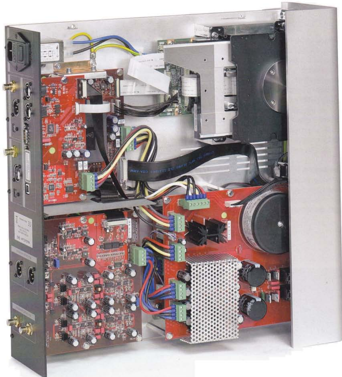
Vier sauber getrennte Baugruppen im Uhrzeigersinn: Laufwerk, Netzteil, Ausgangsstufe, Wandler
